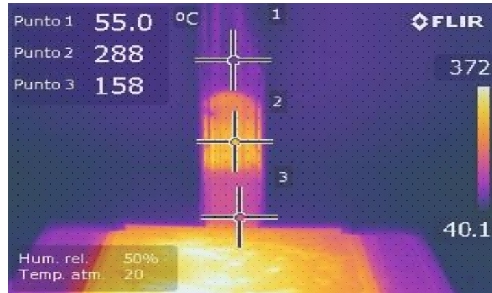
Fig. 6 perfil térmico en chimenea de una estufa
