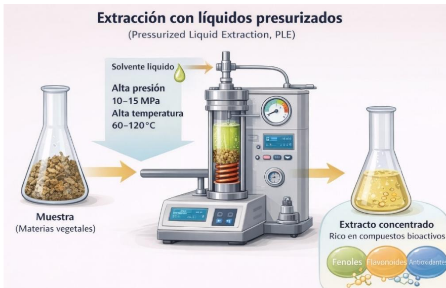
Figura 7. Proceso de extracción de compuestos bioactivos mediante extracción con líquidos presurizados (PLE).
