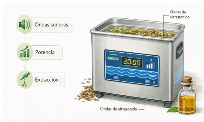
Figura 10. Esquema del método de extracción asistida por ultrasonido basado en cavitación acústica.
