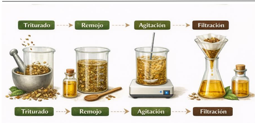
Figura 3. Representación esquemática de la extracción de compuestos fenólicos mediante maceración.
