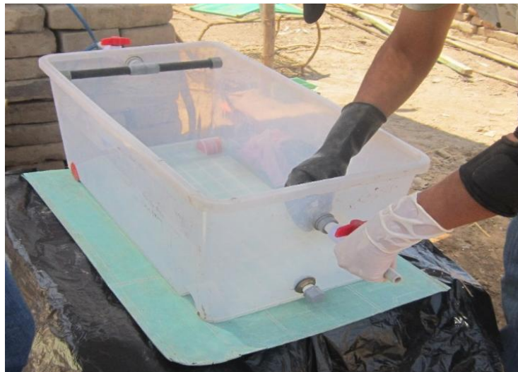
Figura 5. Armado y colocación de tuberías.
