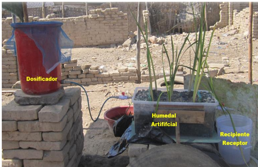
Figura 8. Puesta en operación del sistema de humedal artificial piloto
