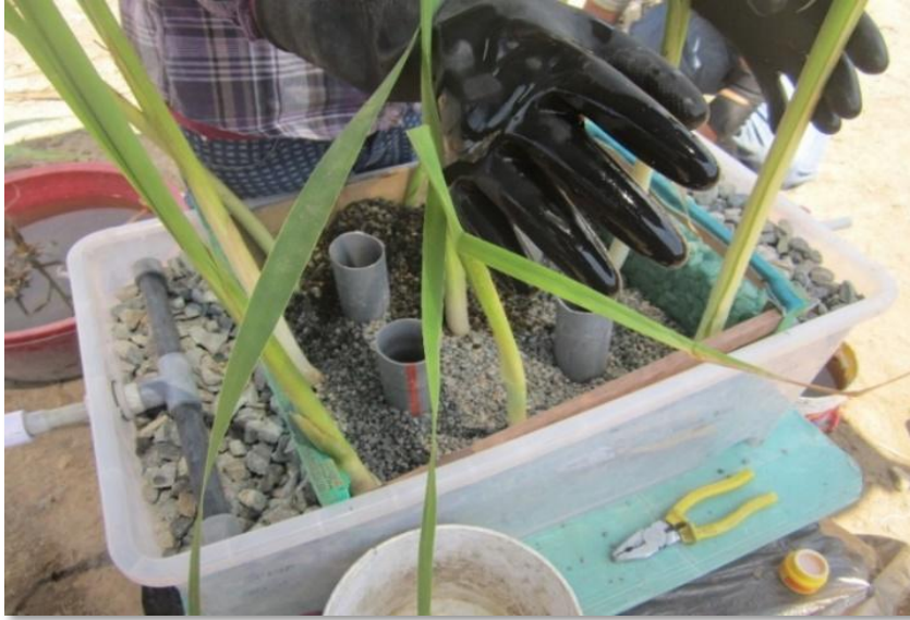
Figura 7. Puesta en operación del sistema humedal artificial piloto
